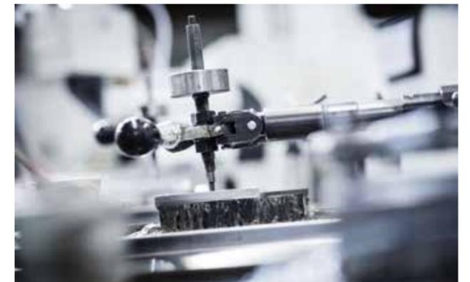
Mit höchster Präzision wird eine Linse aus BOROFLOAT® geschliffen.
