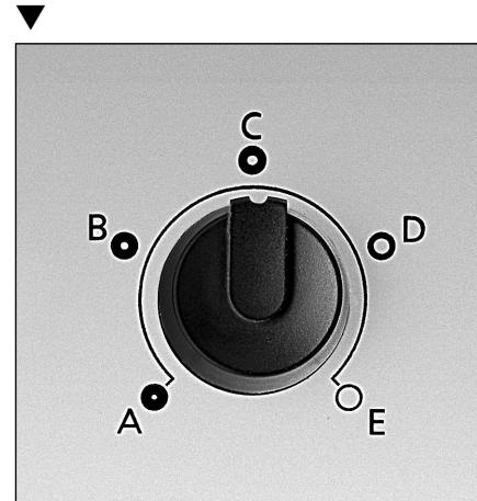
Sur la position A, l'intensité lumineuse est la plus faible, alors que sur la position E (obturateur entièrement ouvert), c'est l'intensité lumineuse maximale qui est obtenue. En tournant le bouton de réglage d'un point d'enclenchement au suivant, vous réglez, à chaque fois, une intensité lumineuse approximativement multipliée ou divisée par deux.
