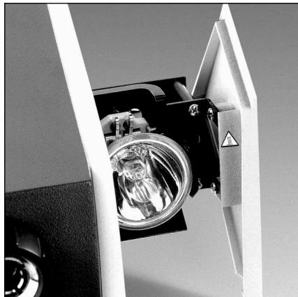
En primer lugar se debe desconectar la fuente de luz. Abrir el compartimiento para la lámpara (10) oprimiendo el botón de desbloqueo (11) y extraer hasta el tope.
