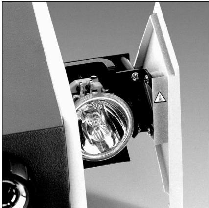
Zunächst die Lichtquelle ausschalten. Lampenfach (10) durch Drücken des Entriegelungsknopfes (11) öffnen und bis zum Anschlag herausziehen. Die beiden Hebel des Spezialsockels herunterdrücken und die defekte Lampe herausziehen.
