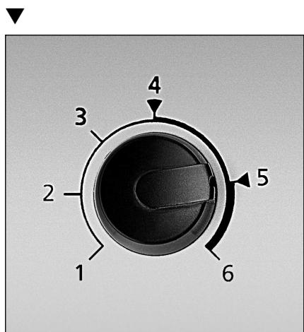
En la posición 1 se da la menor intensidad de luz, la mayor luminosidad se alcanza en posición la 6. Las dos barreras que se encuentran en las posiciones 4 y 5 se superan apretando el botón de ajuste.
