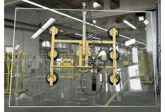
Distribuir uniformemente a lo largo de la superficie del vidrio los puntos de succión de la ventosa hidráulica.
