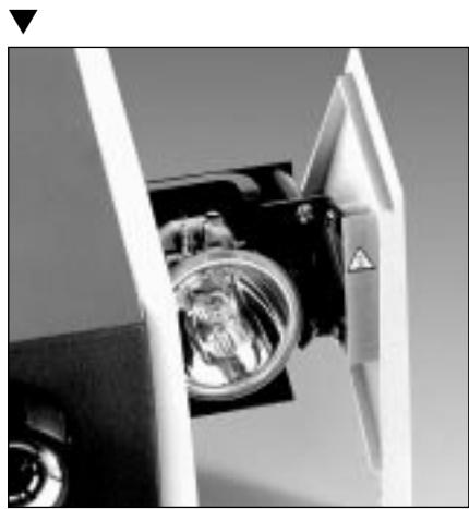
Eteignez, tout d'abord, la source de lumière. Ouvrez le compartiment à lampe (10) en appuyant sur le bouton de déverrouillage (11) et retirez-le jusqu'à la butée. Abaissez les deux leviers du socle spécial, puis sortez la lampe défectueuse.
