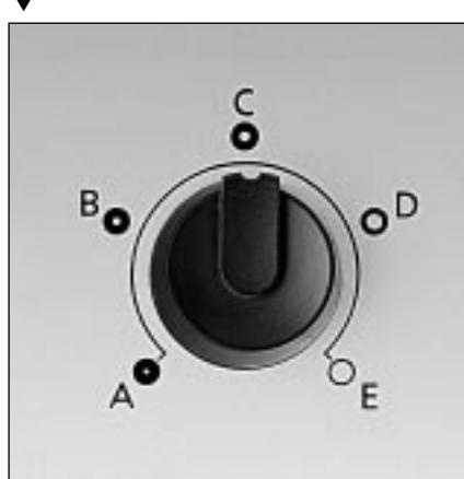
In Position A ergibt sich die geringste Helligkeit, in Position E (vollständig geöffnete Blende) wird die maximale Helligkeit erreicht. Das Drehen des Einstellknopfes von einem Rastpunkt zum nächsten bewirkt jeweils eine ungefähre Verdoppelung bzw. Halbierung der Lichtstärke.
