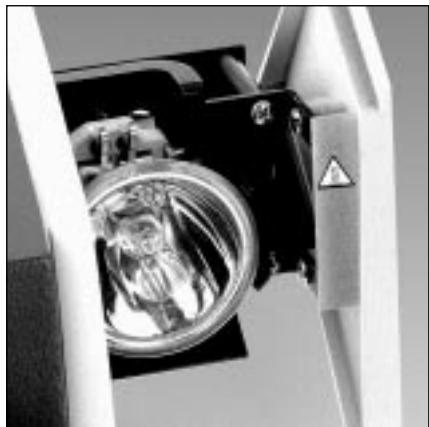
Zunächst die Lichtquelle ausschalten. Lampenfach (10) durch Drücken des Entriegelungsknopfes (11) öffnen und bis zum Anschlag herausziehen.
