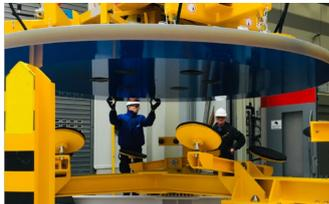
Per Saugheber wird das 4 m-Spiegelsubstrat angehoben, um dann auf der CNC-Bearbeitungsmaschine weiterbearbeitet zu werden. Der M3 ist bei der Lieferung nur noch 10 Zentimeter dick und wiegt 3200 Kilogramm. Foto: SCHOTT
