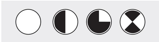
Beim Ring Light Plus können Sie die Segmenteinstellung schrittweise drehen oder auch in Dauerrotation versetzen. Der Rotations-Betrieb erhöht den Eindruck der Dreidimensionalität strukturierter Objekte, besonders beim Betrachten am Monitor.
