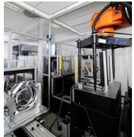
图2: 12英寸 DIRECT100, 机械手将样本 放入空腔。
