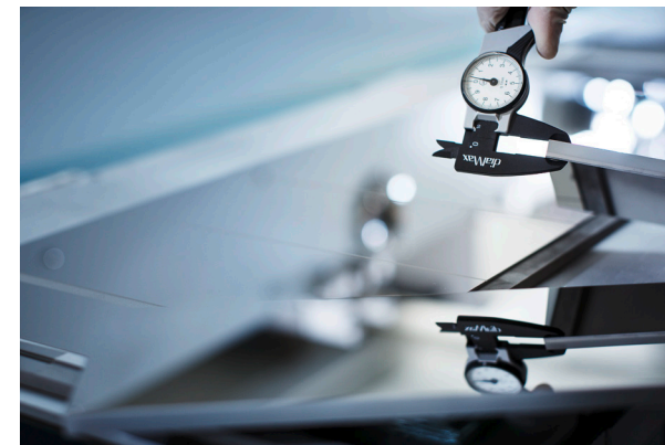
pic_03: Messung im Tausendstel Millimeter-Bereich
