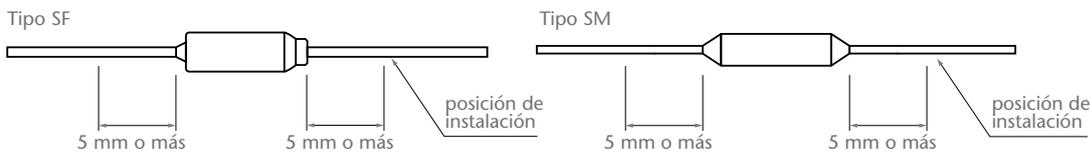
Si se suelda, tenga en cuenta que el fusible térmico puede activarse debido a una temperatura de soldadura excesiva. Para evitar este tipo de fallos, por ejemplo, sujete el cable cerca de la carcasa con una herramienta para dejar que se disipe el calor y realice la soldadura en intervalos cortos.
