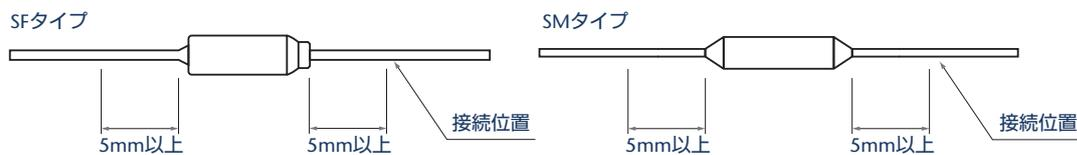
半田付けする場合には、半田付け時の熱によって温度ヒューズがダメージを受けたりしないように注意してください。半田付け後に温度ヒューズが動作していなくても、ダメージを受けていると、その後の使用で早切れを起こしたり、動作しなくなるおそれがあります。したがって、作業条件を最悪条件にして半田付けを行い、温度ヒューズがダメージを受けていないかを確認してください。この確認作業は、ご依頼があれば当社にて行います。
