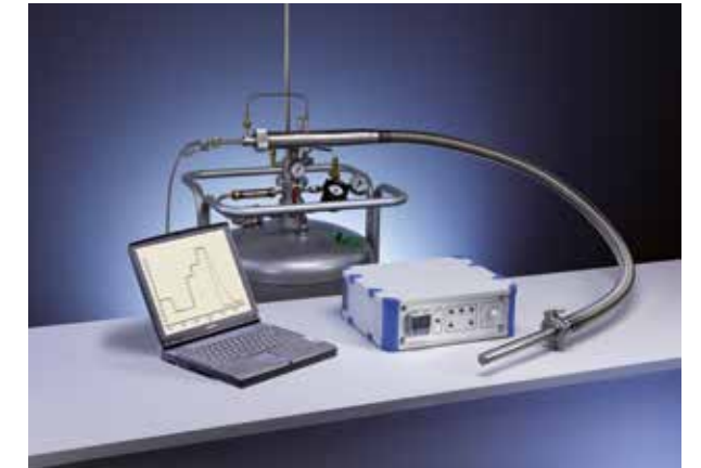
KALTGAS-System Typ TG-LKF-H für einen Temperaturbereich von +120^{\circ}\text{C} bis -180^{\circ}\text{C} , mit einer Temperaturstabilität bis \pm 0,2^{\circ}\text{C} .
