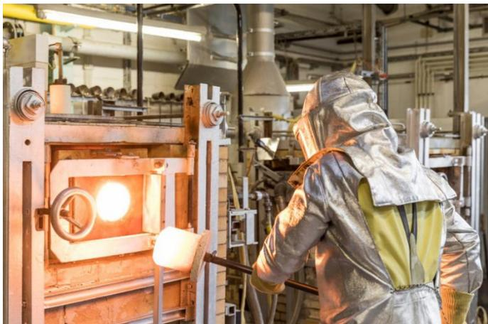
特种玻璃制造需要消耗大量能源，熔化温度可达 1700 摄氏度。供图：肖特
