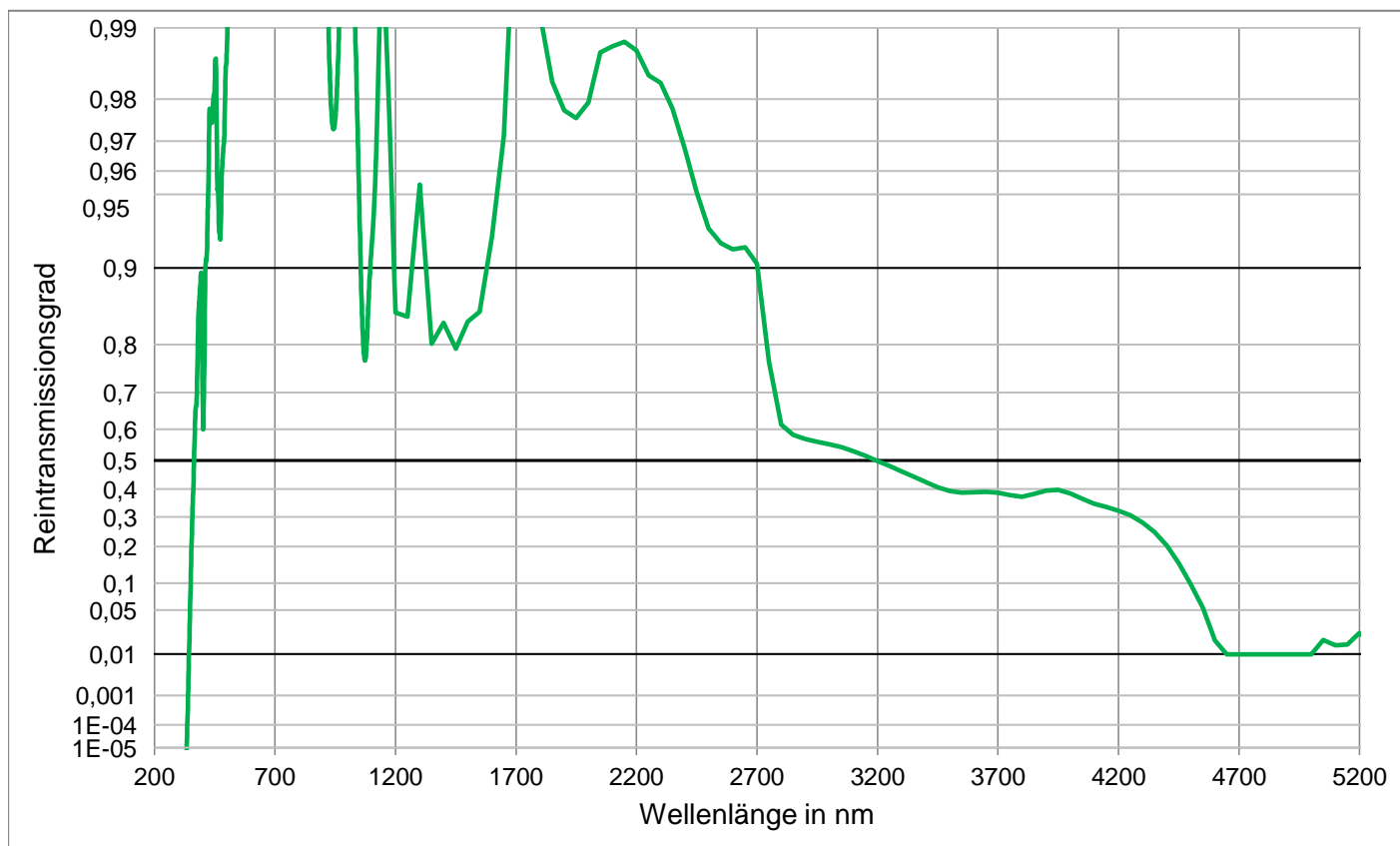
Reintransmissionsgrad \tau_i bei der Referenzdicke Die Reintransmissionsgrade, tabellarisch und graphisch, sind als Richtwerte zu verstehen.
