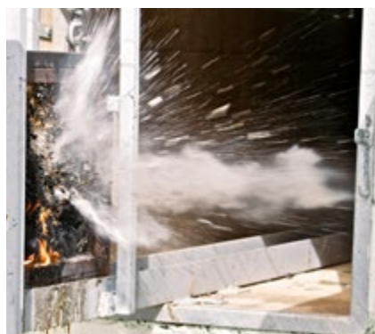
Test: Beschussversuch nach Kleinbrandversuch
