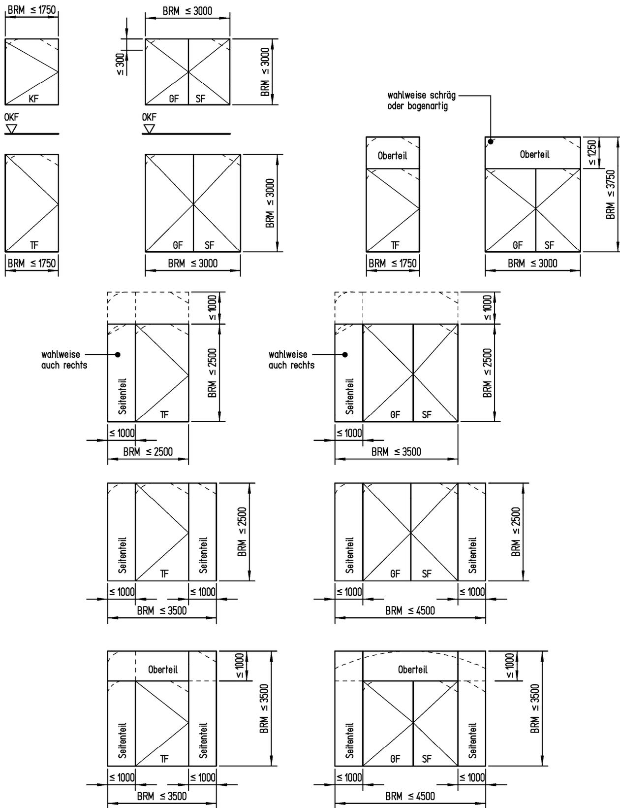
T 30-1-FSA "neuform-Typ BASIC" bzw. T 30-1-RS-FSA "neuform-Typ BASIC" bzw. T 30-2-FSA "neuform-Typ BASIC" bzw. T 30-2-RS-FSA "neuform-Typ BASIC"
