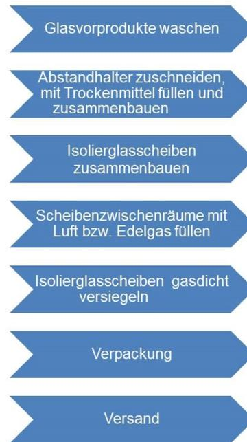
Glasscheiben werden mit einem oder mehreren Abstandhalterprofilen aus Edelstahl oder Stahl auf den gewünschten Abstand gebracht und mit Hilfe von zwei Dichtstoff-Ebenen verbunden sowie gasdicht versiegelt. Die Scheibenzwischenräume werden mit Luft- oder Edelgas (Argon) gefüllt.
