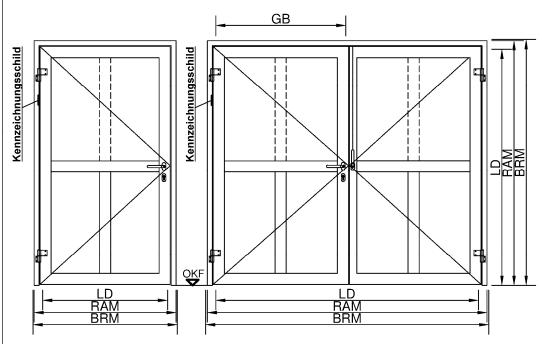
Bei Verwendung eines Falztreibriegels in zweiflügeligen Türen im Zuge von Rettungswegen steht als Rettungswegbreite nur die Öffnungsbreite des Gangflügels zur Verfügung.
