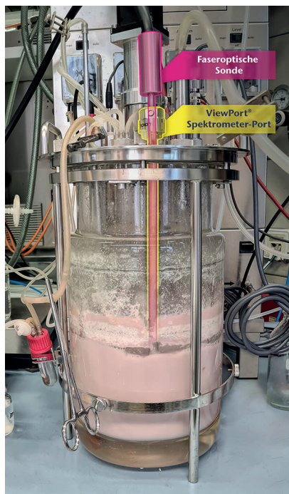
Abbildung 1: Versuchsaufbau: Rührkessel-Fermenter mit faseroptischer Sonde und Spektrometer-Port (Quelle: Hans-Knöll-Institut, Schott).
